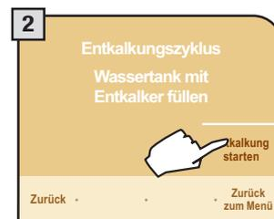
Wenn die Maschine gesperrt wird, erscheint auf dem Display die Meldung "Wassertank mit Entkalker füllen". Die Entkalkung wie beschrieben durch Drücken von "Entkalkung starten" durchführen.
