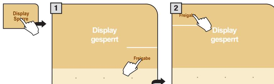
Um das Display erneut zu aktivieren, "Freigabe" unten rechts und anschließend (innerhalb von zwei Sekunden) "Freigabe" oben links drücken (diese Taste erscheint erst nach dem Drücken der vorhergehenden Taste).
