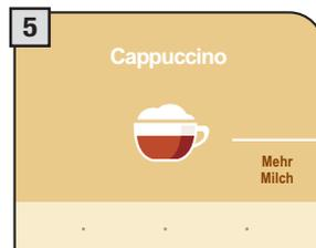
Sofern gewünscht, kann die Maschine anschließend eine zusätzliche Menge an Milch ausgeben. Diese Option bleibt ca. 2 Sekunden lang aktiv und wird durch Drücken der Taste "Mehr Milch" aktiviert.
