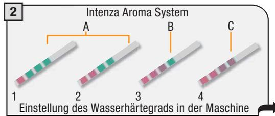
Den Wert des Teststreifens für die Wasserhärte ablesen.
