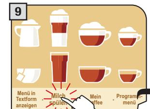
Die Maschine fordert zur Spülung des Milchsystems auf; die Taste blinkt. "Milch spülen" drücken, um die Milchleitungen zu reinigen.
