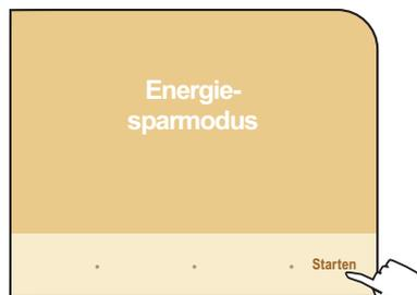
Zum Aktivieren der Maschine "Starten" drücken. Nach Durchführung der Funktionsdiagnose und der Aufwärmphase ist die Maschine erneut betriebsbereit.
