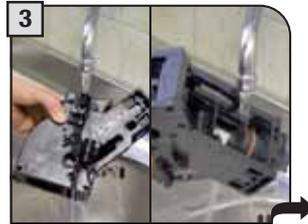
Die Brühgruppe von Kaffeeresten reinigen. Den oberen Filter unter fließendem Wasser reinigen.
