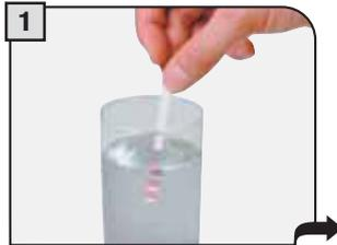
Den beige-packten Prüfstreifen für die Bestimmung der Wasserhärte eine Sekunde lang ins Wasser halten in das in der Maschine befindliche Wasser eintauchen.
