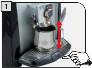
1 Ein Gefäß unter die Heißwasserdüse stellen (es kann sein, dass aus der Düse kein Wasser austritt).
