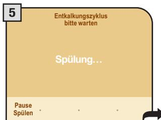
Die Maschine führt die Spülung durch. Nach dem Spülzyklus wird man zum Auffüllen des Tanks mit frischem Trinkwasser aufgefordert. Bevor der Tank wieder gefüllt wird, soweit gewünscht, den Wasserfilter erneut einsetzen oder den kleinen weißen Filter wieder einsetzen (siehe Seite 7).
