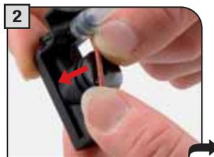
2 Den neuen O-Ring durch sanften Druck einsetzen.
