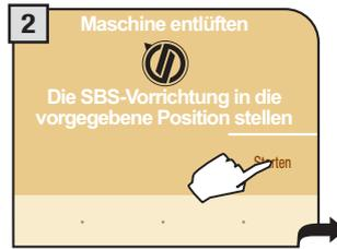
2 Einmal auf das Display drücken; die Maschine startet den Entlüftungszyklus.
