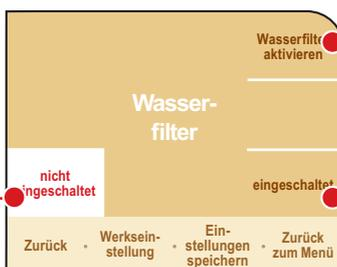
die Maschine für den Betrieb ohne den Wasserfilter einstellen.
