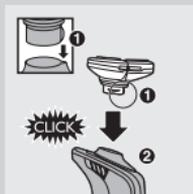
**7** Inserite la linguetta nell'unità di rasatura nella fessura posta nella parte superiore del rasoio (1). A questo punto, premete l'unità di rasatura verso il basso (2) finché il rasoio non scatta in posizione.
