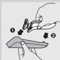
**4** Introduza a parte superior da máquina de barbear no Power Pod (1) e pressione a parte inferior para o Power Pod (2).
