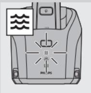
► La spia di lavaggio inizia a lampeggiare e il rasoio viene automaticamente abbassato nel liquido detergente.
