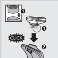
**2** Insérez la languette de la nouvelle unité de rasage dans la fente du rasoir prévue à cet effet (1). Attachez ensuite l'unité de rasage au rasoir en faisant glisser le taquet vers le bas (2) (clic).
