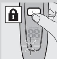
*Hinweis: Wenn Sie den Rasierer in den eingesteckten PowerPod oder in das JetClean System stecken, wird die Reisesicherung automatisch deaktiviert.*
