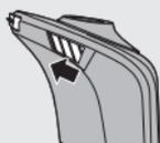
**3** Schieben Sie den Schiebeschalter für den Langhaarschneider nach vorne. Der Langhaarschneider wird herausgeschoben.
