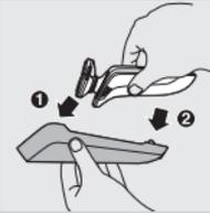
**4** Power Pod'a (1) önce tıraş makinesinin üstünü takın ve ardından alt kısmını Power Pod'un (2) içine itin.
