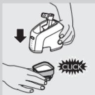
**6** Placez le système Jet Clean sur la cuve. Assurez-vous que les boutons de déverrouillage se remettent en place.
