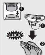
**7** Stecken Sie die Führung der Schereinheit in den Schlitz oben am Rasierer (1). Drücken Sie die Schereinheit dann nach unten (2), so dass sie mit einem “Klick” auf dem Rasierer einrastet.
