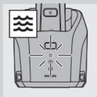
▶ Het schoonmaaklampje begint te knipperen en het scheerapparaat zakt automatisch in de reinigingsvloeistof.
