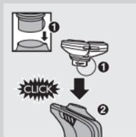
**7** Introduza a saliência da unidade de corte na ranhura na parte superior da máquina de barbear (1). Pressione a unidade de corte para baixo (2) para a encaixar na máquina de barbear ('clique').
