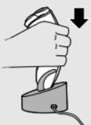
È possibile ricaricare l'apparecchio posizionandolo sull'apposita unità di ricarica, se fornita.
