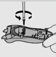
**6** Retirez le couvercle du bloc d'alimentation à l'aide d'un tournevis.
