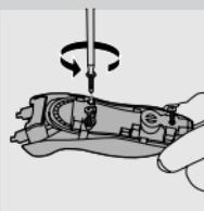
**6** Rimuovete il coperchio del gruppo di alimentazione mediante un giravite.
