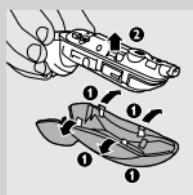
**3** Desaperte os dois parafusos da câmara de recolha dos pêlos.
