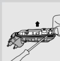
**4** Desaperte os três parafusos da unidade de alimentação.
