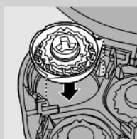
Asegúrese de que los salientes de los cabezales de afeitado encajan exactamente en las ranuras.
