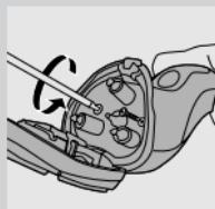
**2** Deixe a máquina de barbear a trabalhar até parar e desaperte os dois parafusos na parte de trás da máquina.
