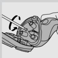
**2** Laissez le rasoir fonctionner jusqu'à l'arrêt complet du moteur, puis ôtez les deux vis à l'arrière de l'appareil.
