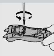
**6** Retire a cobertura da unidade de alimentação com a ajuda de uma chave de parafusos.
